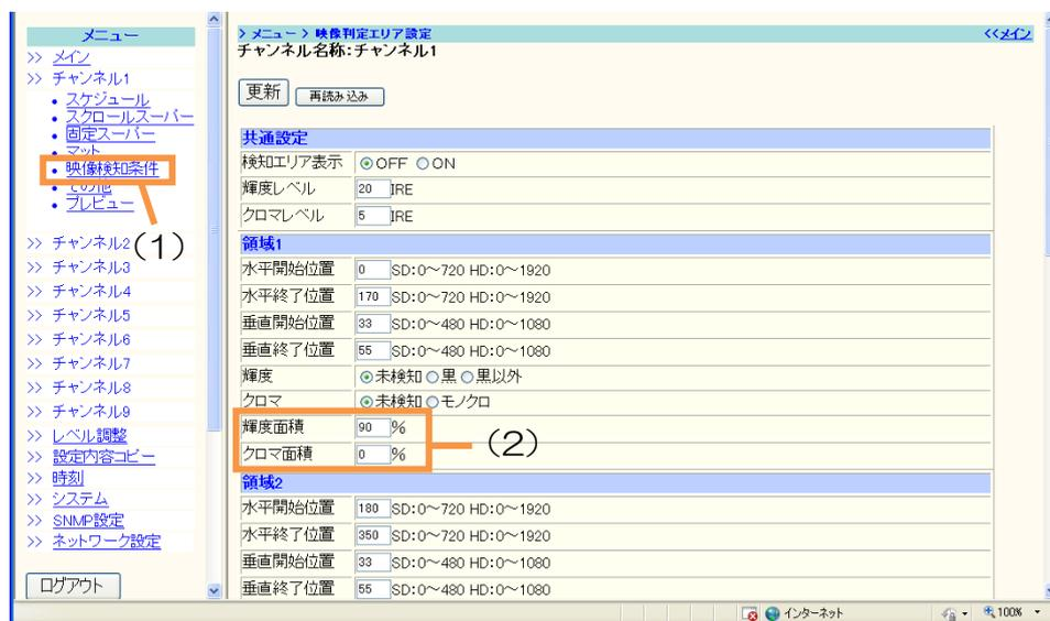
図 2-6-5 映像検知面積設定
