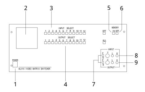
1.電源スイッチ < POWER >電源コードをコンセントにさし、このスイッチを上側にすることにより、電源スイッチ(赤のランプ)が点灯し、電源が入ります。
